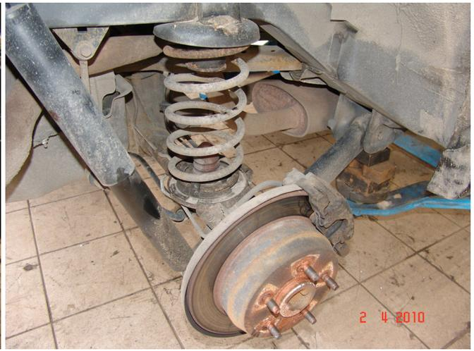
Cały montaż związany z wymianą jest bardzo prosty i nie nastąpił żadnych trudności. Jedynym problemem była tylko konieczność zeszlifowania dolnej tulei w amortyzatorach tylnych o 2 mm (po 1 mm z każdej strony) zaś do górnego uchwytu amortyzatora trzeba było podłożyć podkładkę o grubości 2 mm. Po zamontowaniu wygląda to tak:
