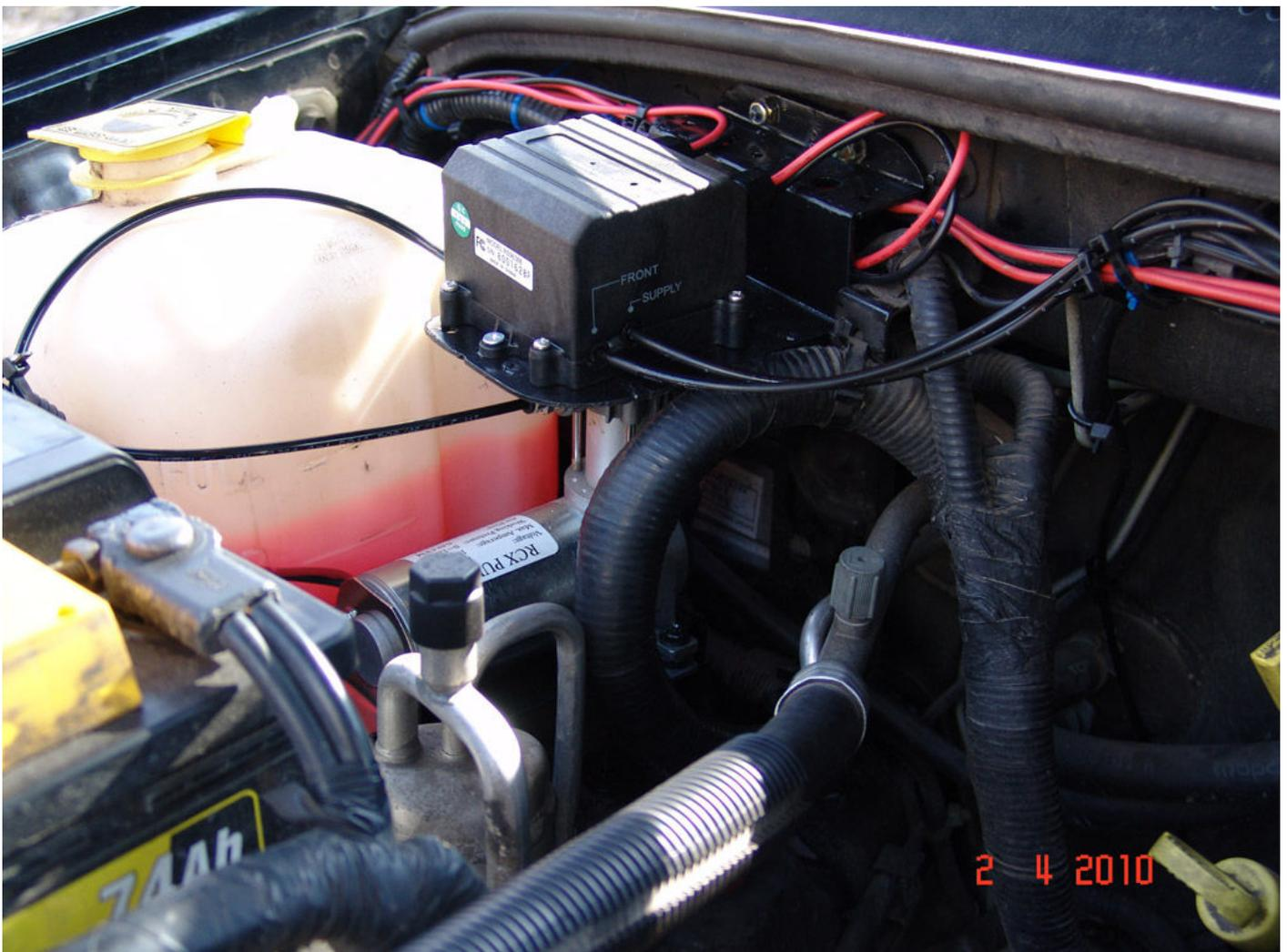
Pozostało tylko wykonać jeszcze podłączenia kompresora z centralką i doprowadzenie przewodów zasilających, które zostaną podłączone do instalacji elektrycznej dopiero po zainstalowaniu całego systemu.
